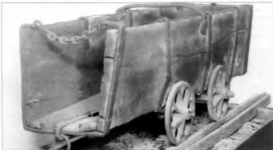
Alte Kohlenlore. Auf solchen Gefährten wurden die Kohlen mit der Grubenbahn befördert
